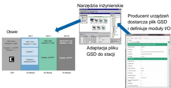
Rys. 9: Przypisanie parametrów w pliku GSD do stacji IO device podczas konfiguracji systemu
